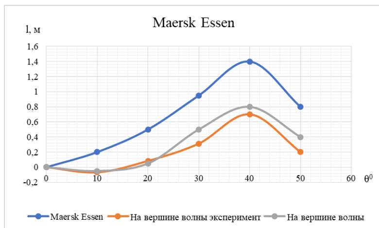
Рисунок 7 – Диаграммы статической остойчивости контейнеровоза Maersk Essen на тихой воде и на вершине волны
