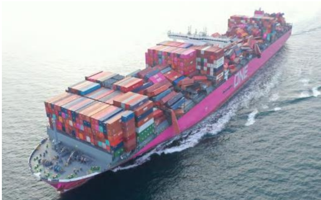
Рисунок 1 – Повреждение груза на контейнеровозе One Arus в результате параметрического резонанса [1]
