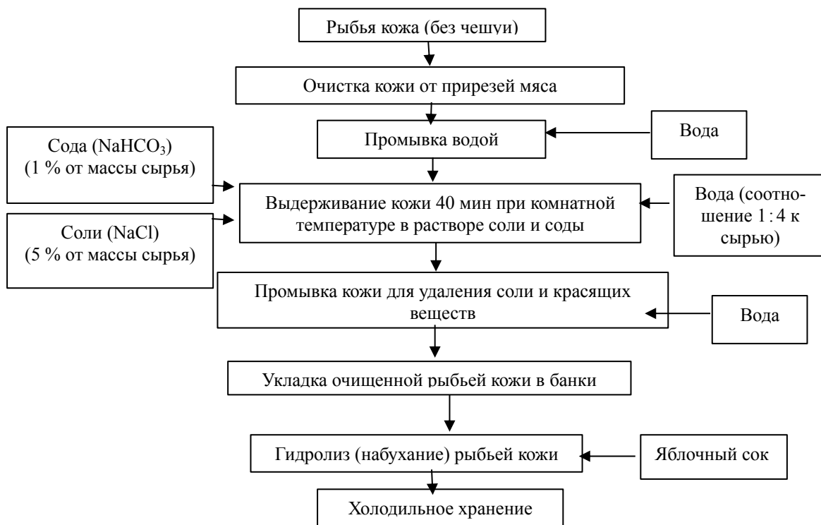
Рисунок 2 – Технологическая схема получения ГК из кожи минтая
