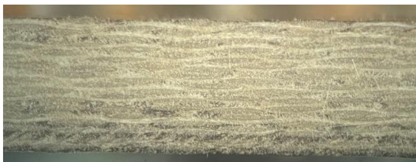
Рисунок 2 – Фото образца после эксперимента № 2 ( V = 140 м/мин, S = 0,017 мм/зуб)
