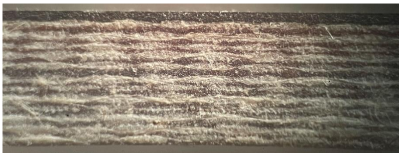
Рисунок 1 – Фото образца после эксперимента № 1 ( V = 42 м/мин, S = 0,044 мм/зуб)
