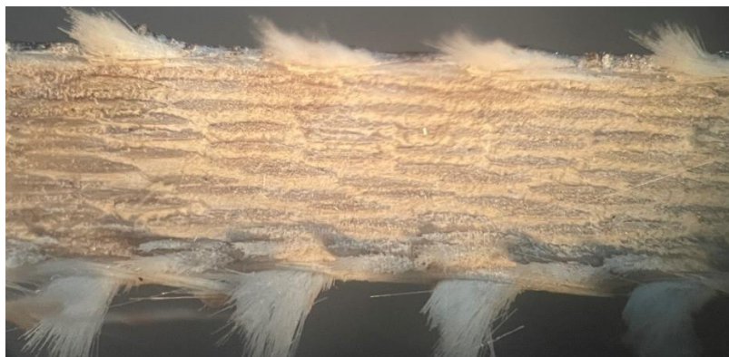
Рисунок 3 – Фото образца после эксперимента № 3 ( V = 200 м/мин, S = 0,001 мм/зуб)
