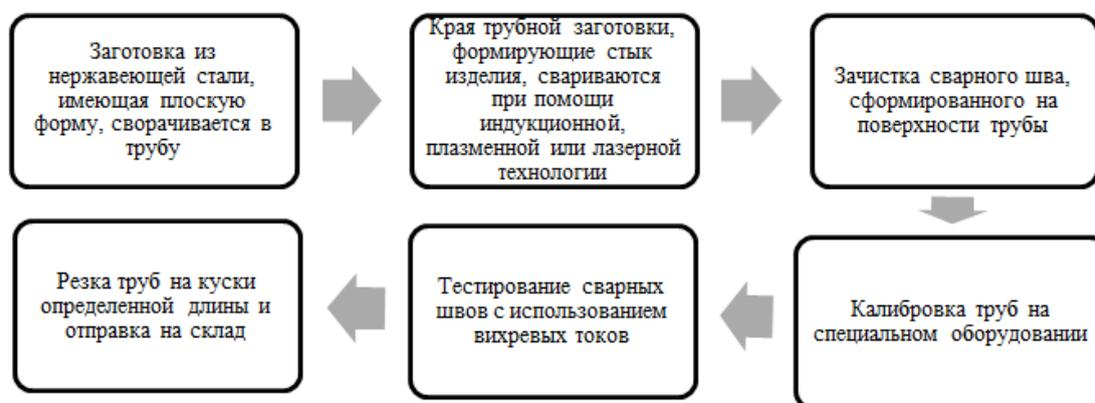
Рисунок 5 – Алгоритм изготовления сварных тонкостенных труб
