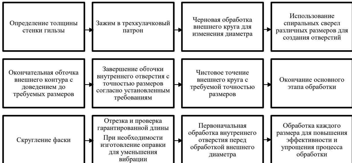
Рисунок 4 – Типовая технология обработки тонкостенной гильзы
