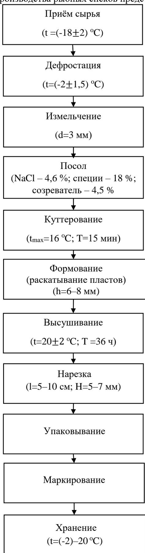
Рисунок 1 – Технологическая схема производства рыбных снеков
