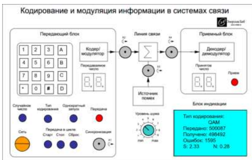
Рисунок 4 – Схема передней панели модуля «Кодирование и модуляция информации в системах связи»
