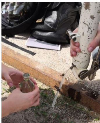
Отбор пробы воды из батометра
