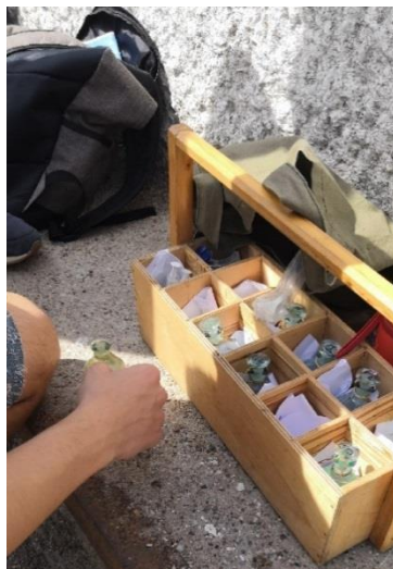
Фиксирование растворенного кислорода по методу Винклера
