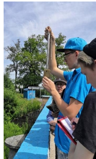
Снятие температуры воды по родниковому термометру
