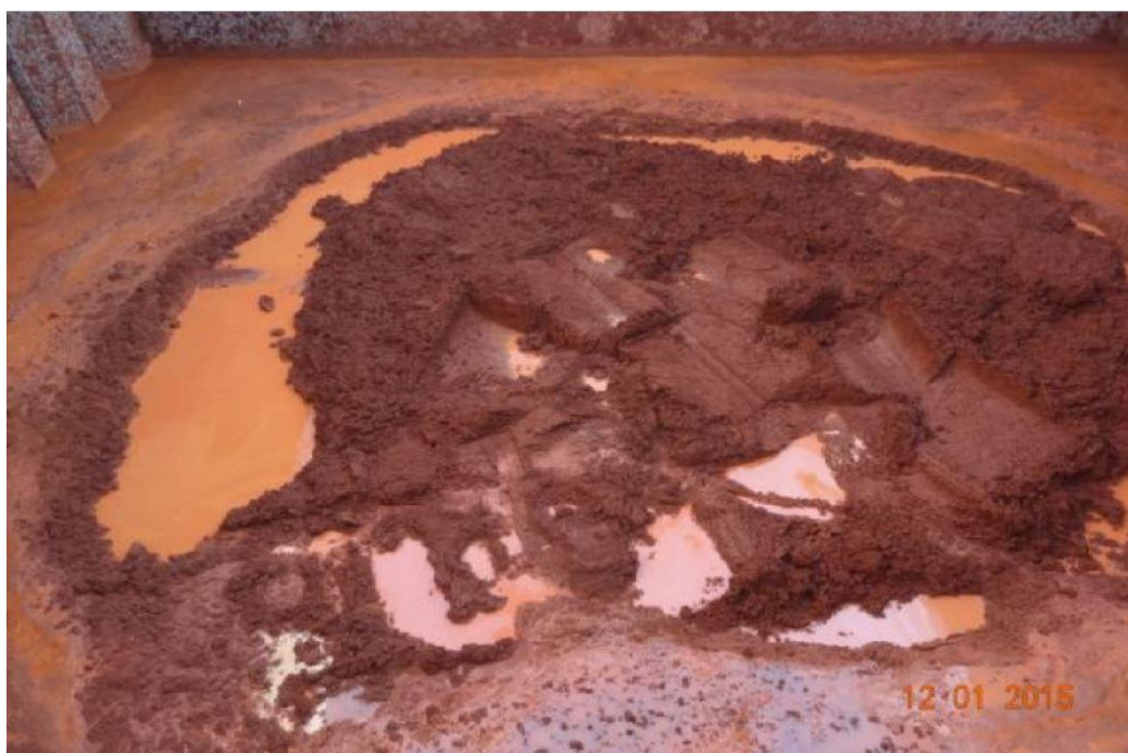
Рисунок 2 – Бокситы после разжижения в трюме м/в «Orchid Island»
