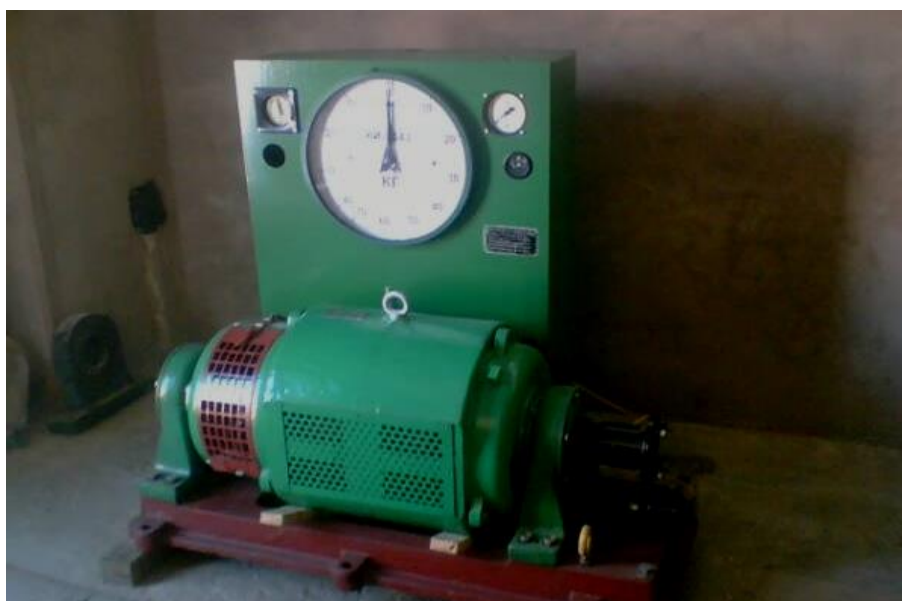
Рисунок 1 – Балансирующая электрическая машина с весовым индикатором для определения крутящего момента
