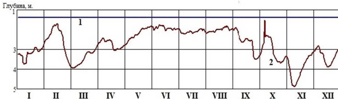
Рисунок 3 – График глубин р. Преголи (гидропост г. Гвардейск) за 2017 г. 1 – проектная глубина; 2 – график глубин.
