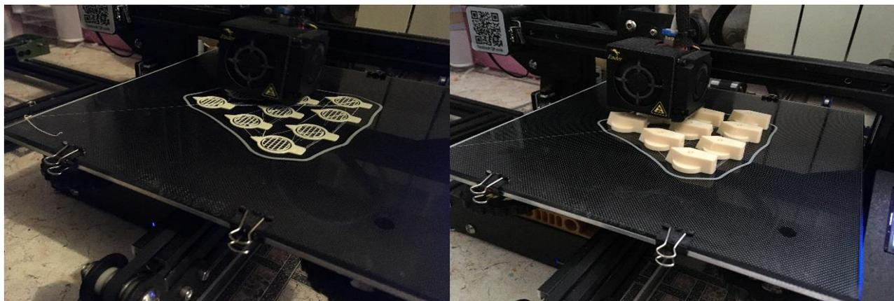
Рисунок 1 – Процесс печати тумблеров и их расположение на платформе принтера
