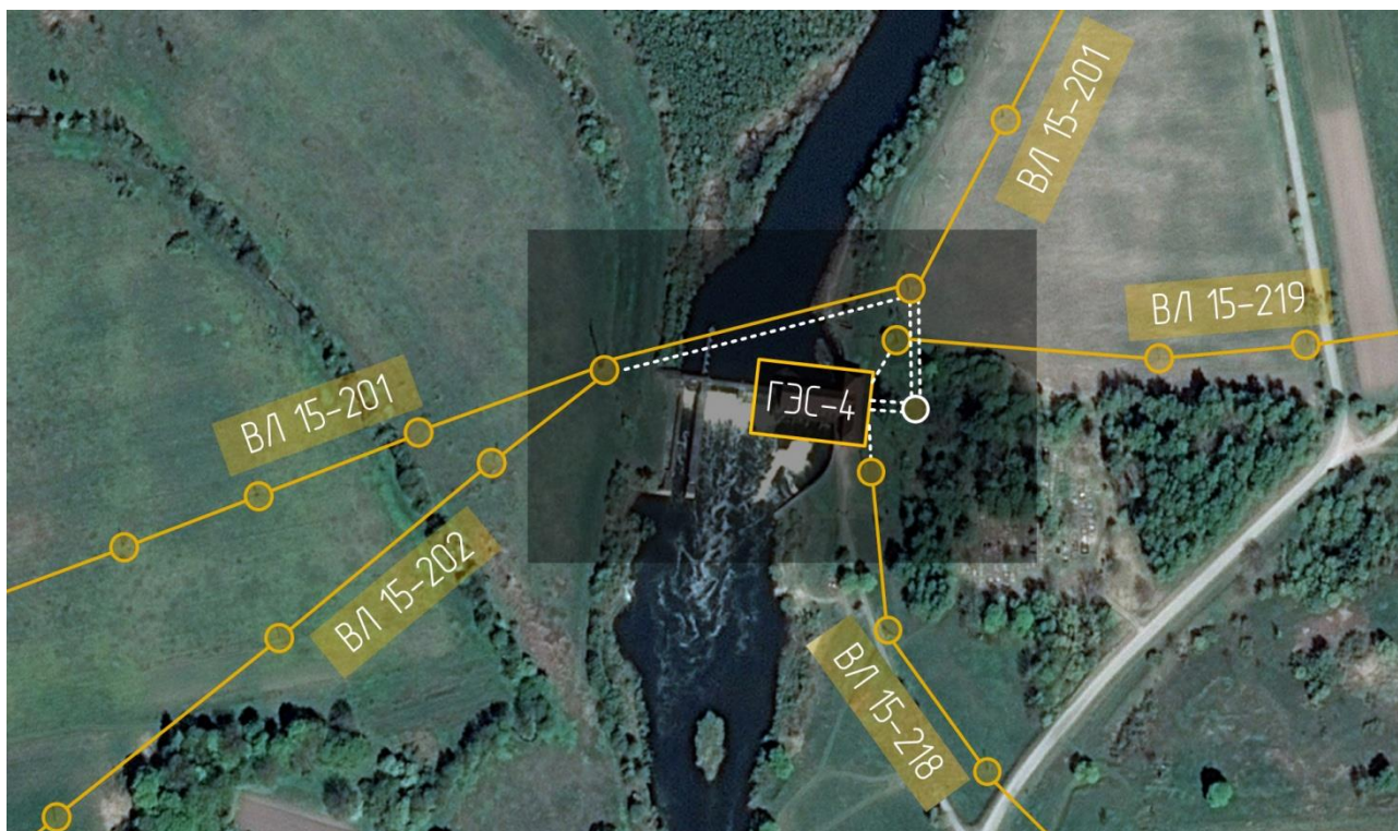
Рисунок 5 – Объем электросетевого строительства (белый цвет) для реализации схемы выдачи мощности Правдинской ГЭС-4 на напряжении 15 кВ
