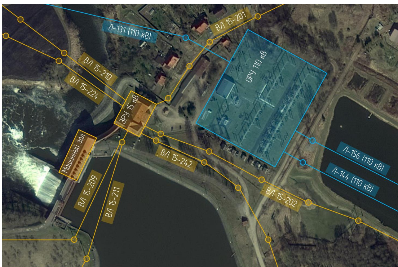
Рисунок 2 – Схема выдачи мощности Правдинской ГЭС-3 в увязке с электрическими сетями района
