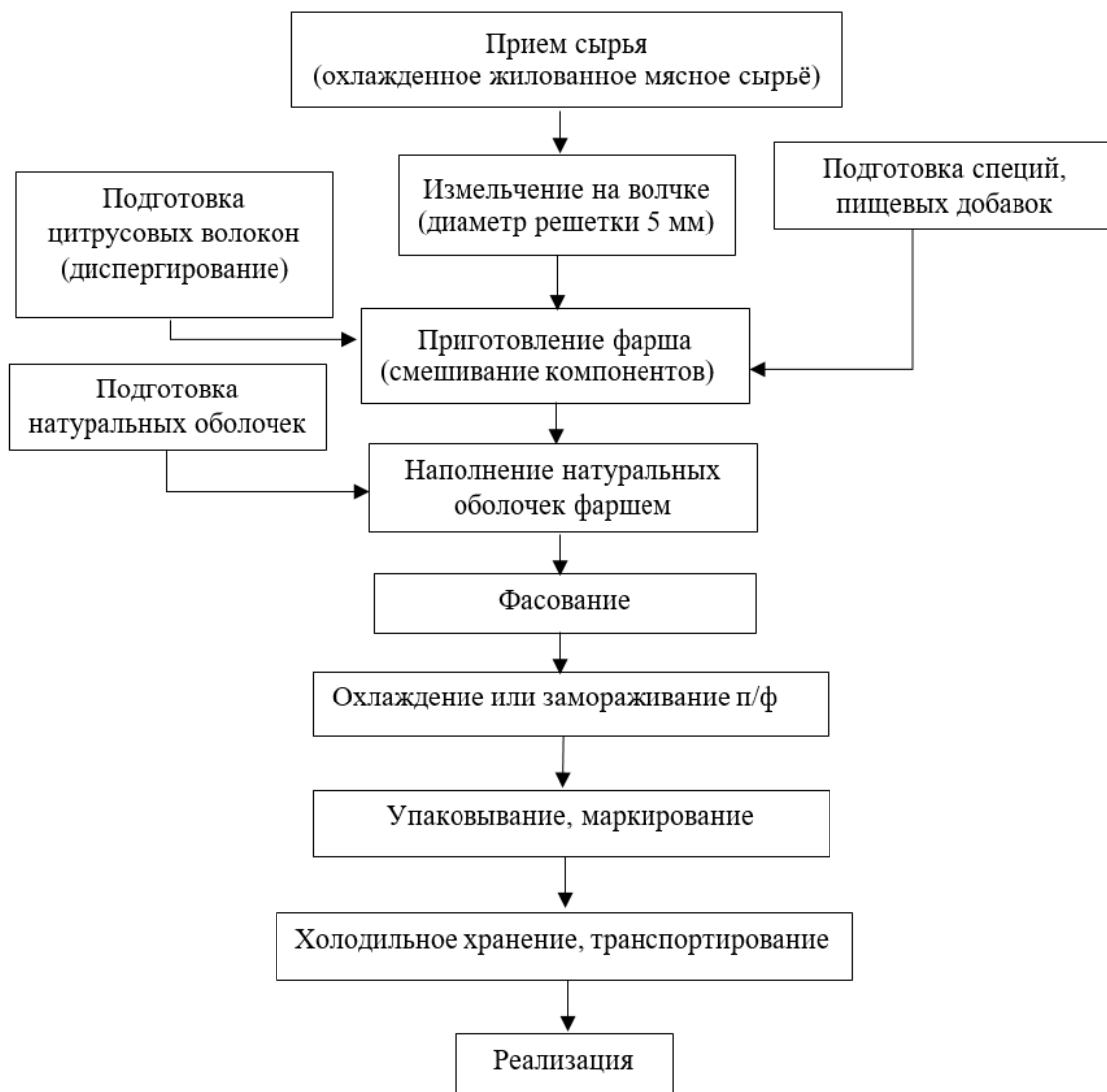
Рисунок 2 – Технологическая схема производства колбасок гриль по традиционной (контроль) и разработанной рецептуре с применением цитрусовых волокон (опыт)
