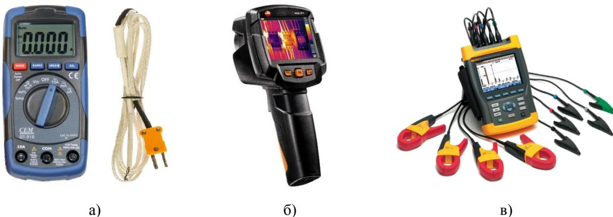
Рисунок 2 – Оборудование для экспериментальных исследований: контактный термометр DT-914 (а), тепловизор Testo 871 (б), анализатор качества электроэнергии Fluke 434 (в)
