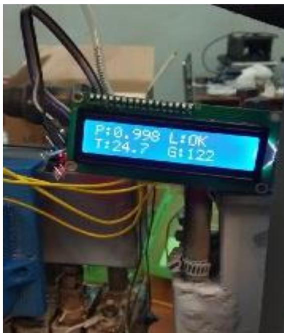
Рисунок 4 – Значения датчиков на дисплее
