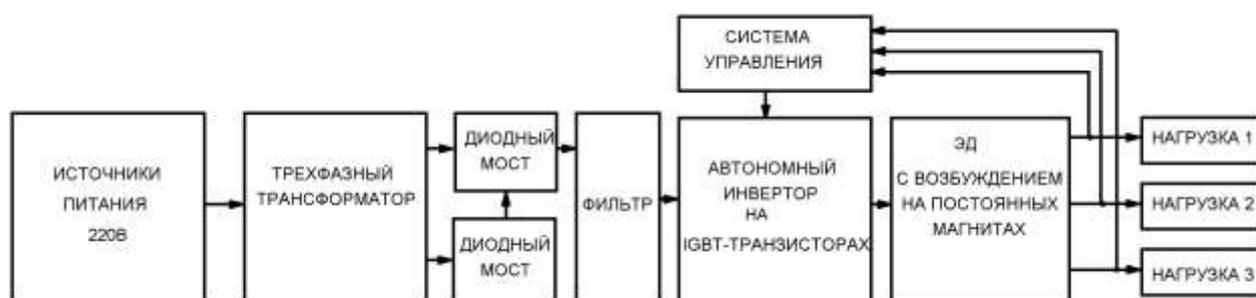
Рисунок 1 – Функциональная схема гребной электрической установки
