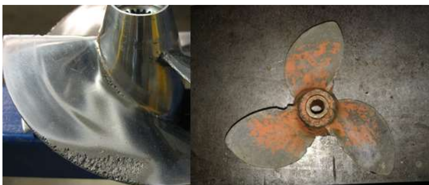
Рисунок 1 – Гребной винт-пропеллер, выведенный из эксплуатации: характерные дефекты вблизи ступицы и нагнетателя есть следствие электрокоррозийного и кавитационного воздействия
