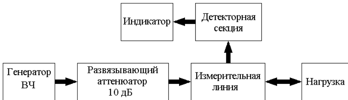
Рисунок 1 - Структурная схема лабораторной установки по исследованию частотной зависимости модуля коэффициента отражения
