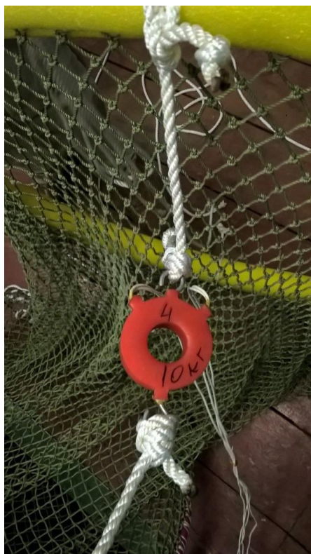
Рисунок 2 – Тензодатчик на якорной оттяжке
