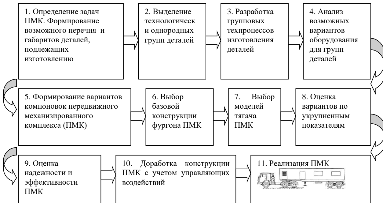
Рисунок 3 – Укрупненная структурная схема последовательности решения задачи оптимизации структур ПМК
