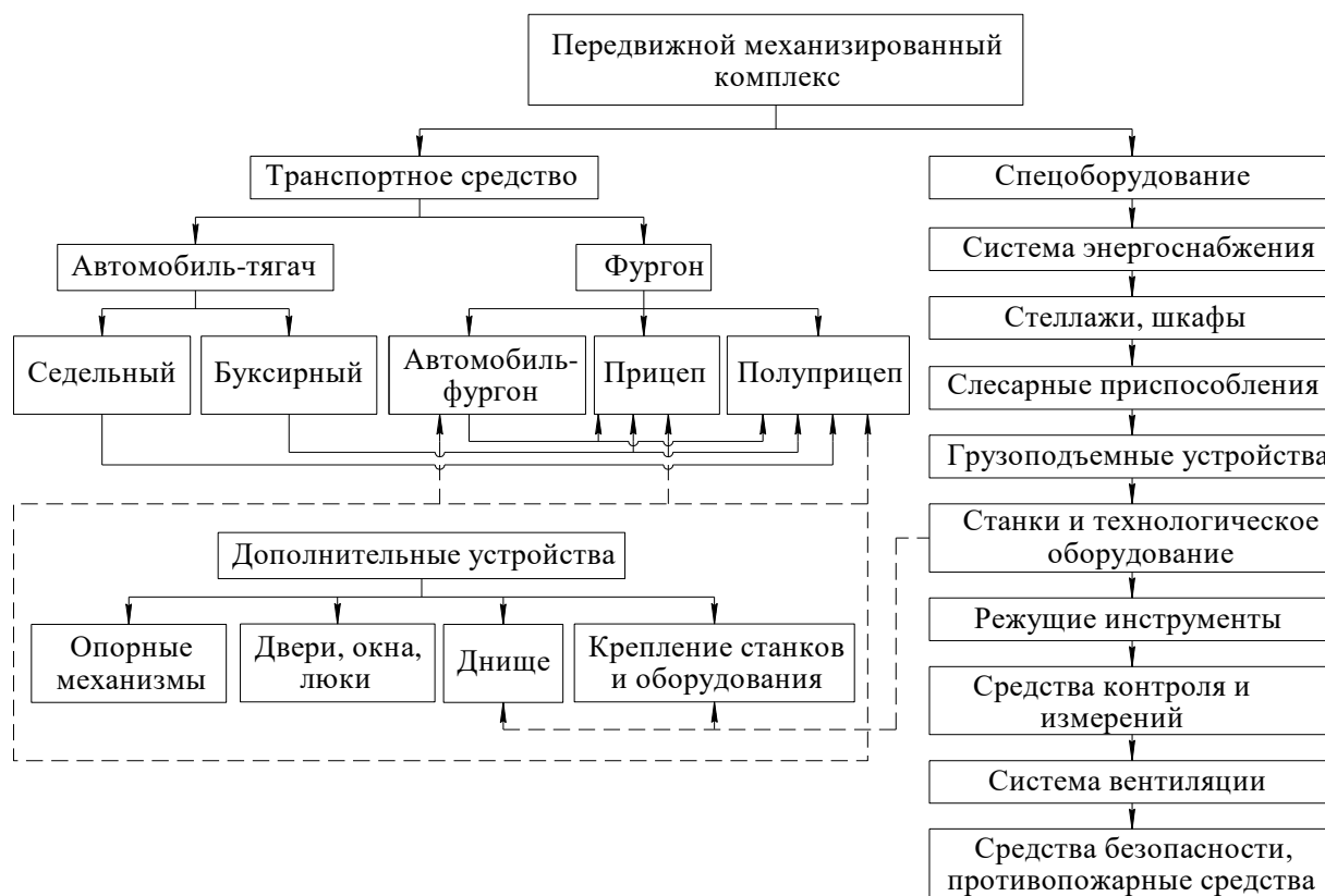
Рисунок 2 – Структурная схема ПМК
