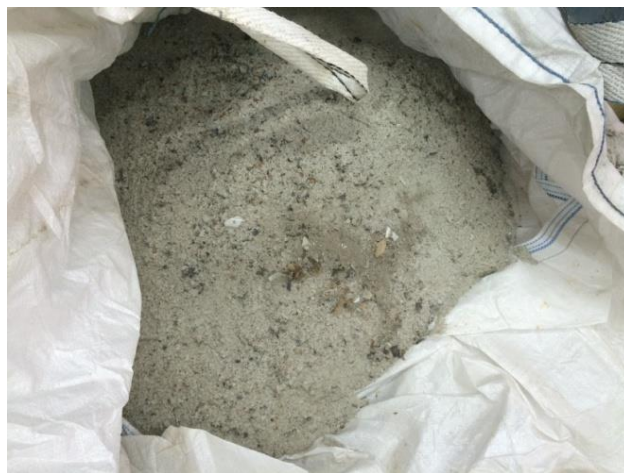
Рисунок 1 – Продукт минерализации люминофора – стеклобой (фото автора)
