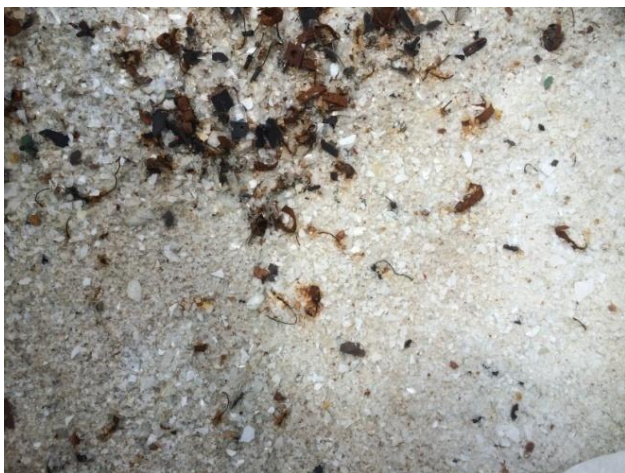
Рисунок 1 – Продукт минерализации люминофора – стеклобой (фото автора)
