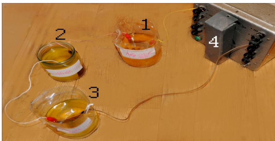
Рисунок 3 – Установка для исследования электрохимической коррозии сварных швов в растворах солей
