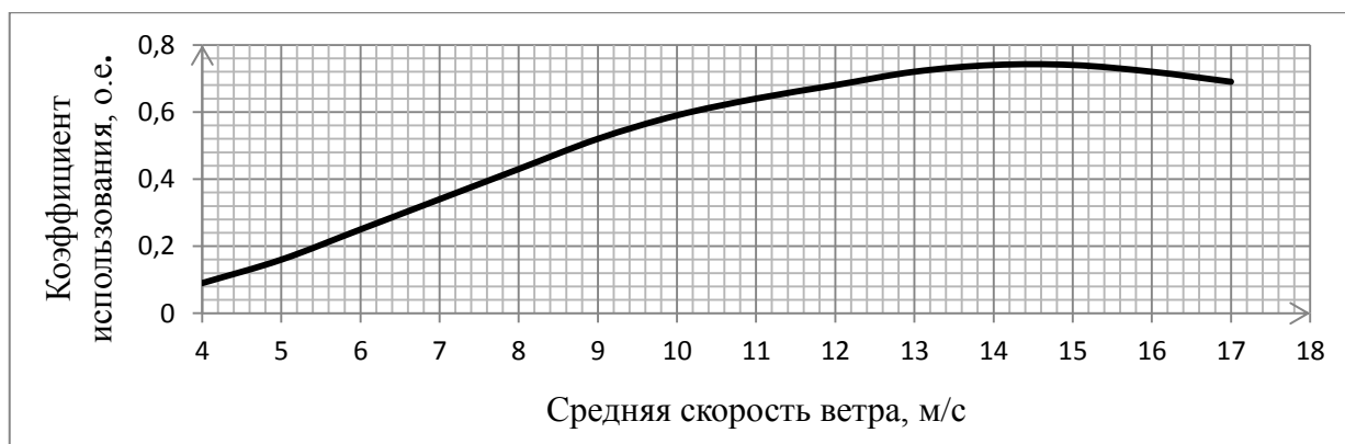
Рисунок 4 – Зависимости коэффициента использования установленной мощности ВЭУ от среднегодовой скорости ветра на уровне ступицы ветроколеса
