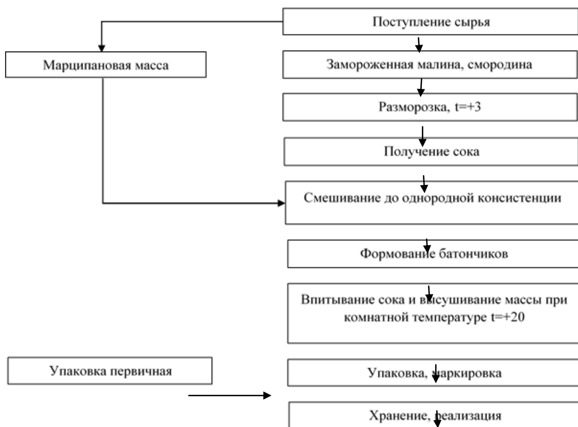
Рисунок – Общая технологическая схема производства функционального продукта на основе марципановой массы с добавлением свежесжатых ягодных соков
