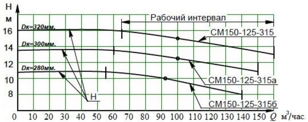
Рисунок 1 – Гидравлические характеристики центробежных, фекальных насосов CM150-125-315 [6]
