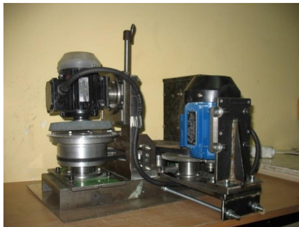
Рисунок 3 - Станок с боковым клиновым зазором: а) схема шлифования и кинематическая структура станка; б – станок, реализованный на кафедре АМС
