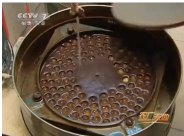
Рисунок 1- Станок с плоскопараллельным клиновым зазором: а – схема шлифования и кинематическая структура станка; б – станок китайского производства [6].
